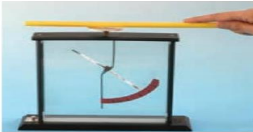
(ب) جسمی باردار را به کلاهک الکتروسکوپ بدون بار نزدیک کرده یا تماس داده ایم .
