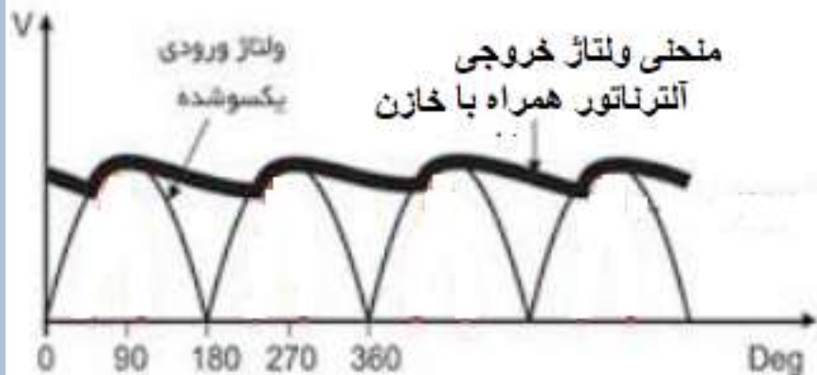
شارژ و دشارژ خازن های ورودی با ولتاژ یکسوسوده
